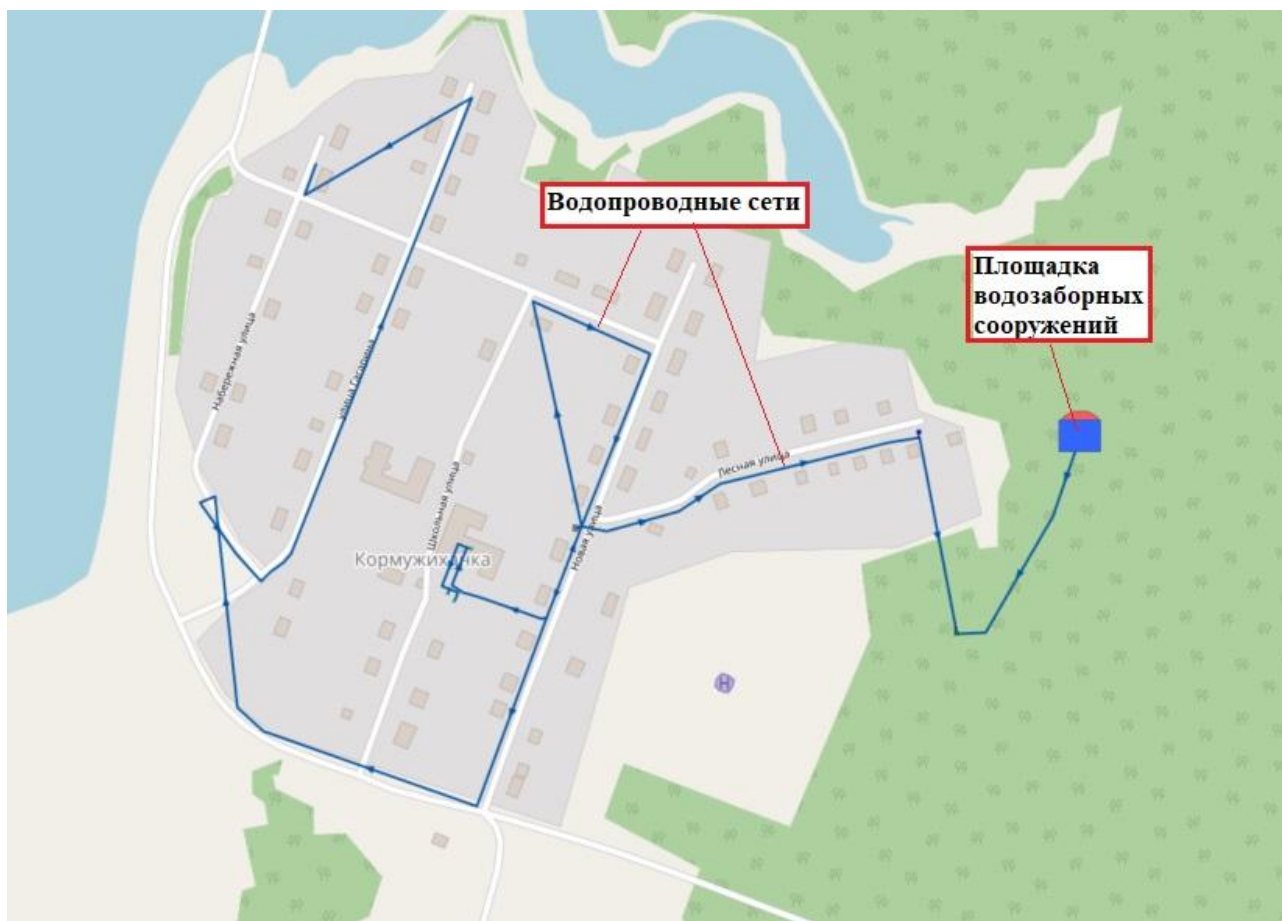
Рисунок 1.1.1.2 – Картограмма зоны действия ТЗ ВС №2 и расположения входящих в них объектов ЦС ХВС
